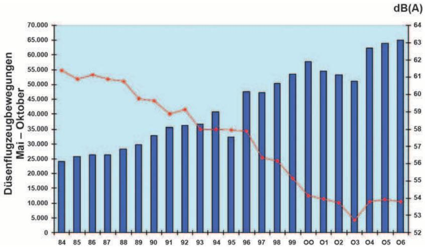
Abbildung 10: Entwicklung Flugbewegungen und Lärm am Beispiel des Flughafens Stuttgart, Auswertezeitraum jeweils Mai bis Oktober (Quelle: Flughafen Stuttgart GmbH)
