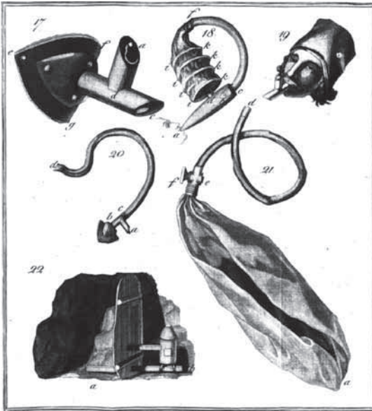
Abbildung 3: Humboldts Atemgerät zur Rettung verunglückter Bergleute. Kupferstich aus Humboldts Buch „Ueber die unterirdischen Gasarten und die Mittel, ihren Nachtheil zu vermindern. Ein Beytrag zur Physik der praktischen Bergbaukunde“, Braunschweig: Vieweg, (1799), Tafel III. Über ein Ventil werden ausgeatmete und aus einem Luftsack eingeatmete Luft getrennt.
